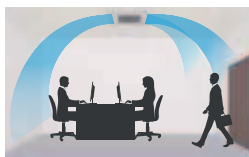
Alto nível de conforto, evitando o fluxo de ar frio direto sobre as pessoas.
