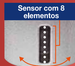
O sensor mede a temperatura enquanto se move da esquerda para a direita
